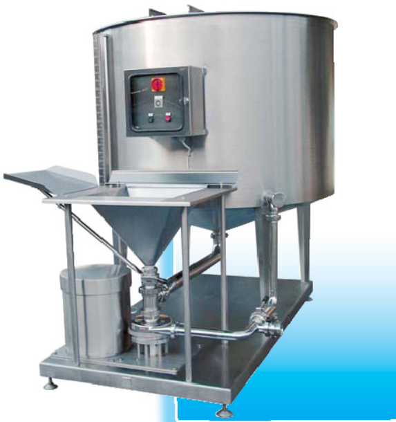
РЕЗЕРВУАР И ДИССОЛЬВЕР В МОНОБЛОЧНОМ ИСПОЛНЕНИИ
