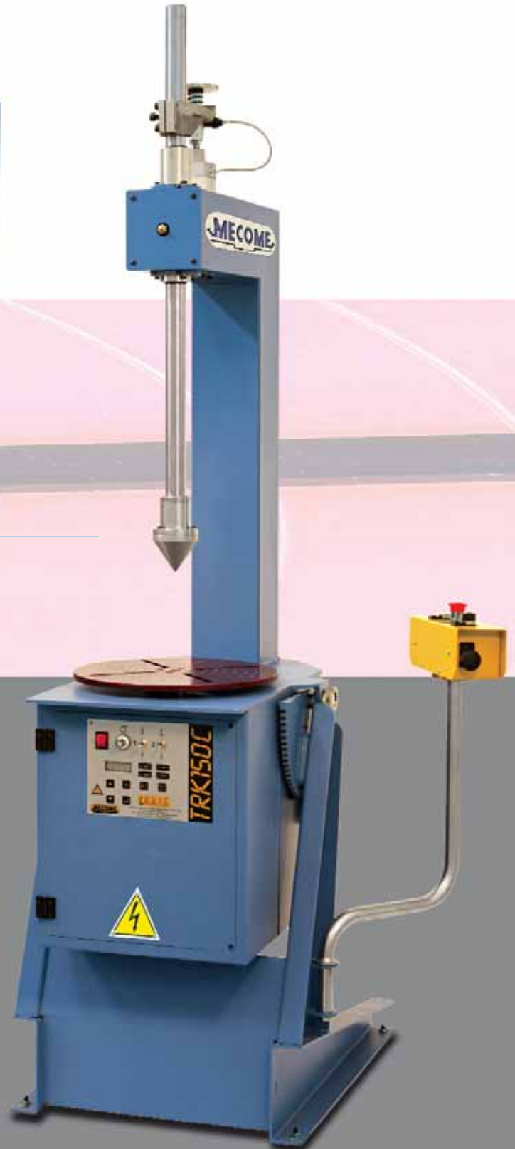
Пневматическая пиноль с переключателем
